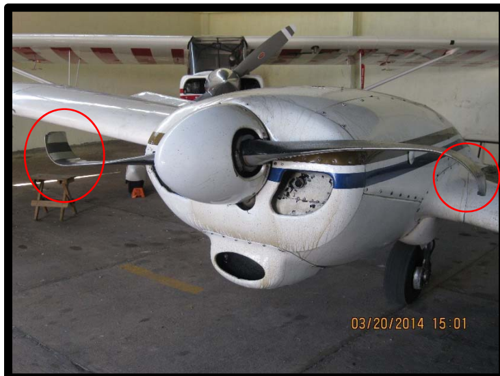
FOTOGRAFIA No. 3 DAÑOS EN LA PARTE FRONTAL DEL MOTOR
