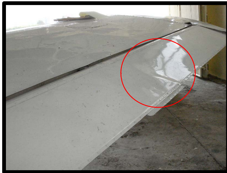
FOTOGRAFIA No.9 EL ALA DERECHA DAÑADA POR EL GOLPE.
